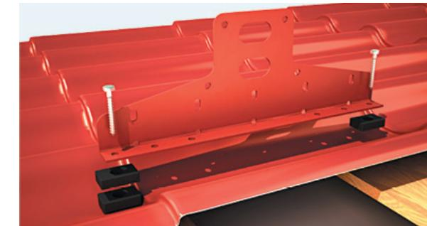
**1** Разместите универсальные кронштейны на кровле и просверлите отверстия. Кронштейны крепятся к доскам обрешетки строго вниз волны. Уплотнители под кронштейны устанавливаются по месту в зависимости от вида кровли.
