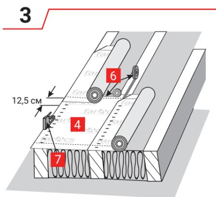
Зафиксируйте мембрану на кровле степлером или гвоздями с широкой шляпкой. Линии перехлеста необходимо соединить двухсторонней монтажной лентой farAcs.
