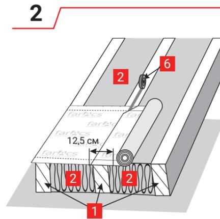
Начиная от карнизного свеса по направлению к коньку, раскатайте рулон горизонтальными полосами внахлест 12,5 см. Для удобства, на рулоне линия нахлеста обозначена пунктирной линией. Для кровли с углом наклона менее 30° рекомендуемый нахлест составляет 20 см.
