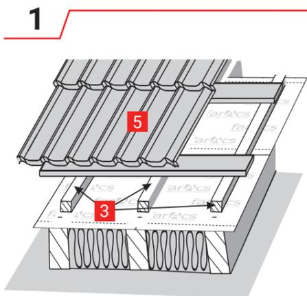
Диффузионная мембрана FARACS используется в конструкциях кровли с вентиляционным зазором. Укладка производится непосредственно на утеплитель без провисания полотна. Нанесенная на мембрану разметка должна располагаться с внешней стороны.
