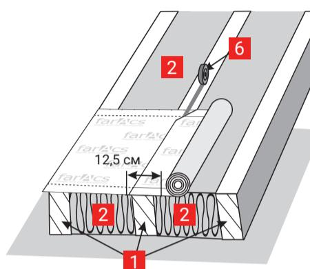
Начиная от карнизного свеса по направлению к коньку, раскатайте рулон горизонтальными полосами внахлест 12,5 см. Для удобства, на рулоне линия нахлеста обозначена пунктирной линией. Для кровли с углом наклона менее 30° рекомендуемый нахлест составляет 20 см.
